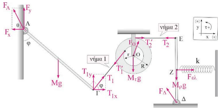
**Δ3.** Οι συνιστώσες της  $T_1$  είναι  $T_{1x} = T_1 \sigma\upsilon\nu\varphi = 6\text{N}$  και  $T_{1y} = T_1 \eta\mu\varphi = 8\text{N}$
